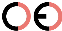
Faux marquage CE (trop éloignée)
